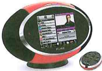
รูปที่ 8 เครื่องรับสัญญาณวิทยุดิจิทัลที่มีจอภาพสามารถแสดงสีสันทัน และสามารถใส่ข้อมูลต่างๆ ได้
