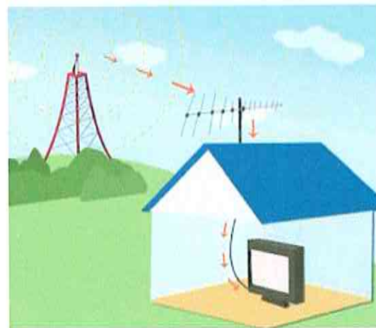
รูปที่ 5 แสดงการรับสัญญาณดิจิทัลของโทรทัศน์ที่มีภาครับสัญญาณดิจิทัลในตัว
